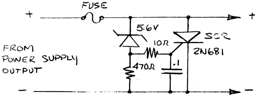
FIGURE 5 STANDARD OVERVOLTAGE CROWBAR
